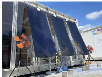
官民協議会を設置し、ペロブスカイト太陽電池の普及を図る(画像は積水化学工業のフィルム型太陽電池)
