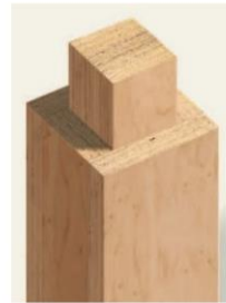
難燃薬剤処理スギLVLで被覆した木質耐火部材 (写真提供：(一社)全国LVL協会)
