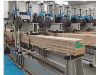
基準強度が定められていないスギCLT(9層9フライ)の強度試験 (写真提供：国立研究開発法人森林研究・整備機構森林総合研究所)
