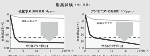
試験機種: アイカ工業(株)R&Dセンター 試験方法: SEK 消臭試験法に準拠 試験臭気: 硫化水素(緑臭臭気)/アンモニア
